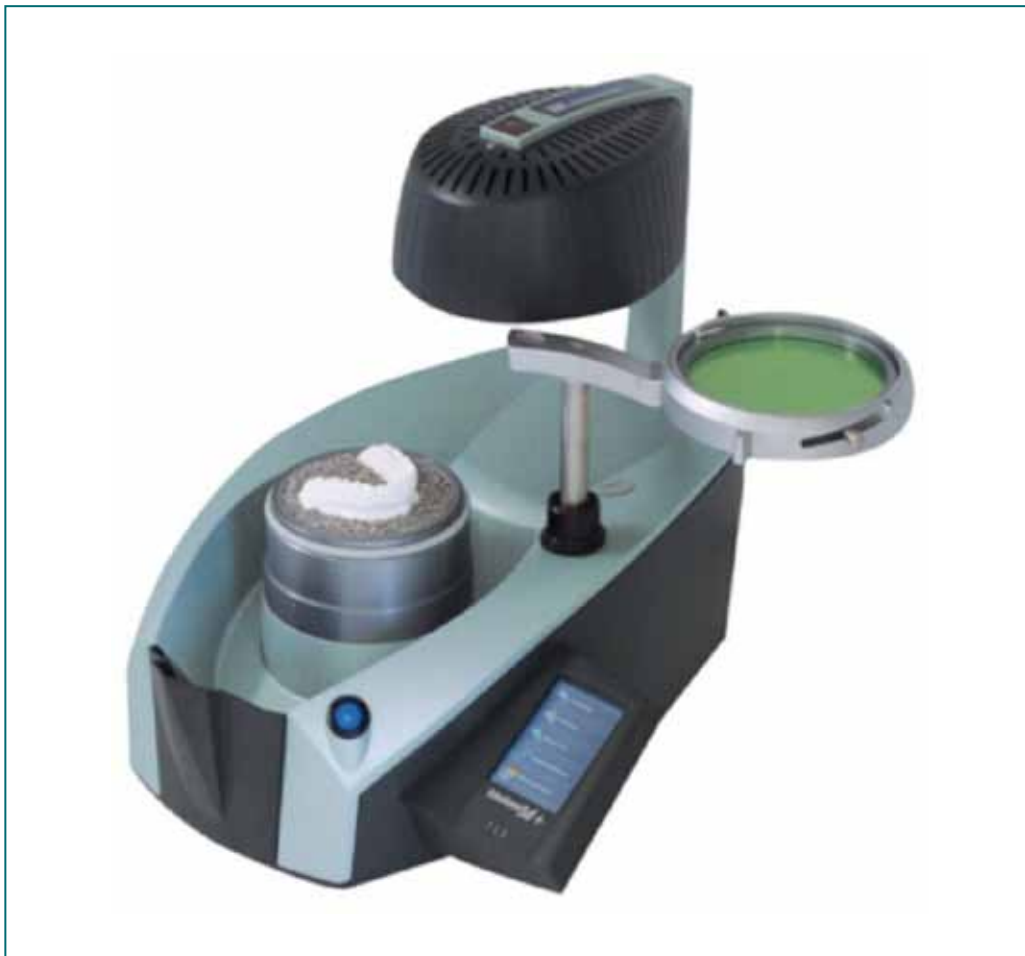
Figura 4. Aparato donde se confeccionan los protectores (Erkoform 3d+, GERL.dental, Alemania) (Erkoform 3d+, GERL.dental, Alemania).
